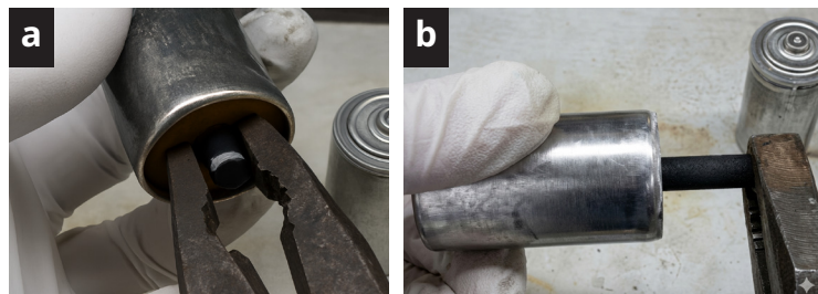
Figura 6. a) Pila sin empaque y b) retiro de barra de carbón.
