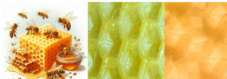
Figura 5. Estructura de la cera de abeja. De izquierda a derecha: 1) imagen de las abejas produciendo la cera (creada en https://designer.microsoft.com/ ), 2) vista macroscópica de la cera de abeja tomada con la cámara de un celular, y 3) microestructura de la cera bajo el microscopio con un aumento 4x (Imagen: Fuentes-Sánchez Lucy B., 2024).
