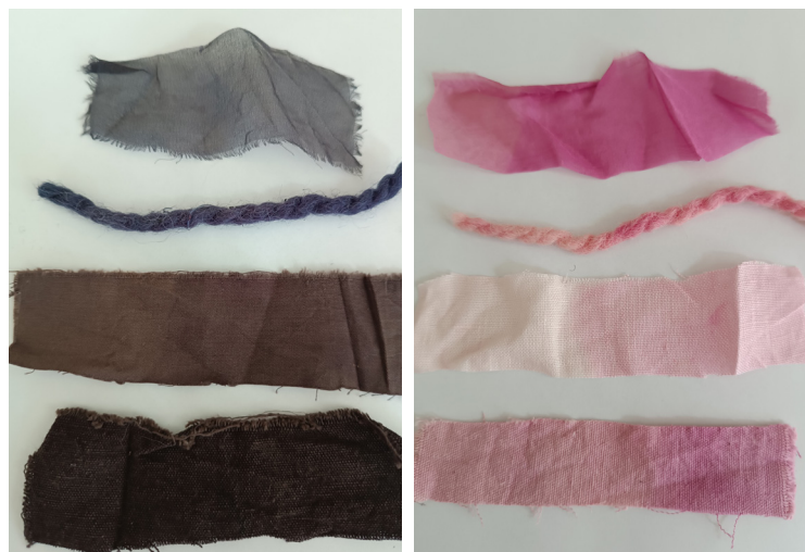
Figura 7. Resultado de las pruebas de resistencia a la exposición solar durante un mes de textiles teñidos con cortezas de palo de Campeche ( Haematoxylum campechianum L.) y cochinilla ( Dactylopius coccus ).
