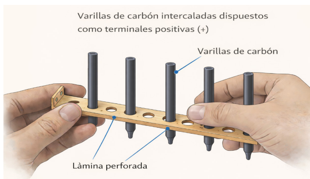
Figura 18. Acomodo de las varillas de carbón sobre la lámina de madera.
