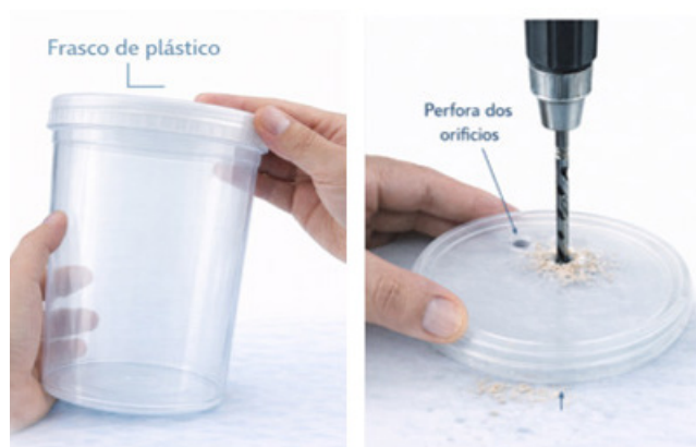
Figura 21. Preparación del contenedor del electrolito.
