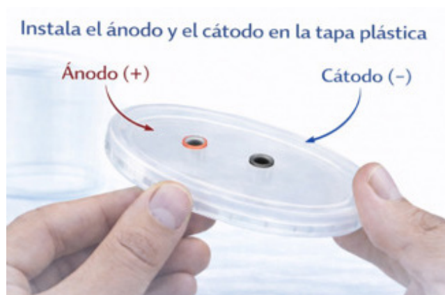
Figura 22. Instalación del ánodo y cátodo.
