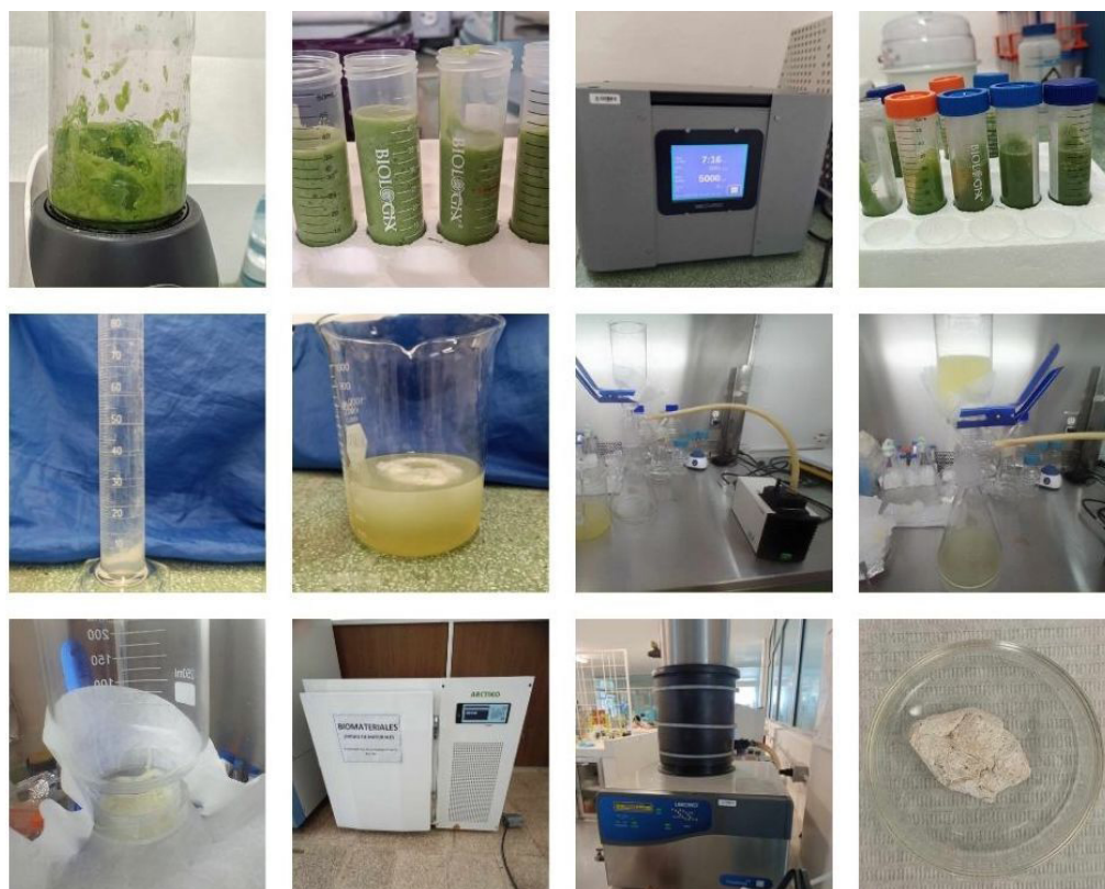
Figura 12. Etapas metodológicas de la extracción técnica del mucílago de nopal (Imagen: Galván-Ramos Maritza, 2024).
